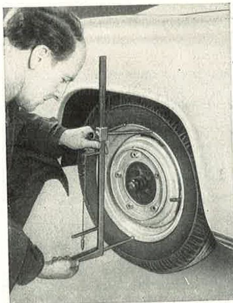
Kuva F 75. Etupyörien pystykallistuma mitataan laitteella W-77 127
