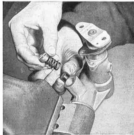
Kuva F 32. Värinäjarrun poistaminen
