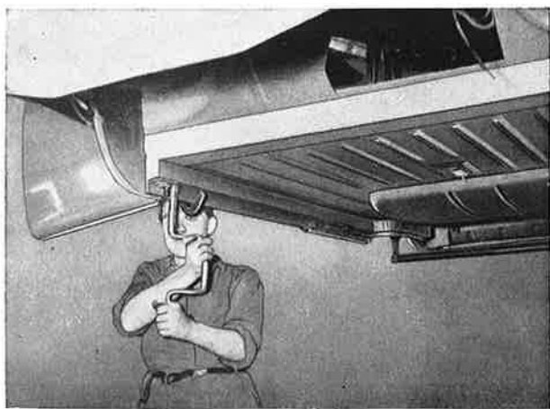
Kuva K 1. Eristetukilevyjen kiinnittäminen korin pohjaan
