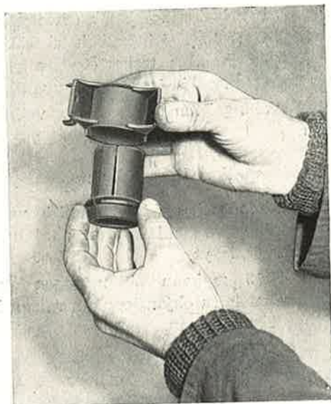
Kuva F 15. Ohjausputken laakeri ja laakeriholkki
