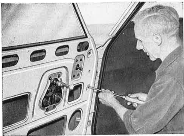
Kuva K 3. Ikkunalasin liukukisko ruuvataan irti
