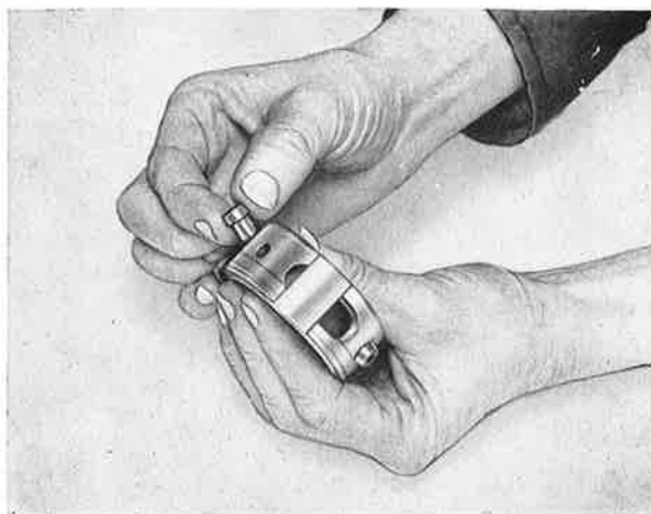
Kuva G 112. Liukuputkien sijoittaminen synkronisointirengaaseen
