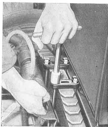
Kuva F 96. Etujousen vaihtaminen
