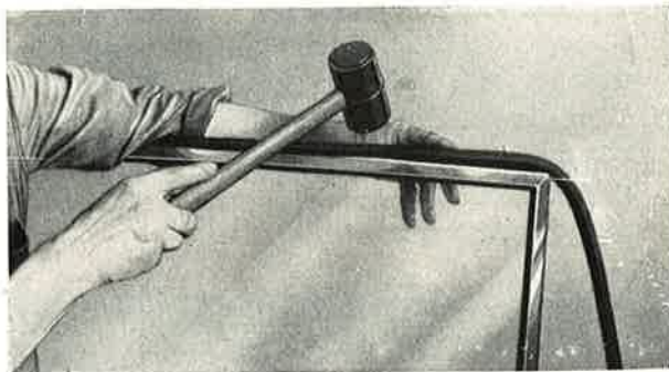
Kuva K 20. Tiivistyskumin kiinnittäminen tuulilasiin kumivasaran avulla
