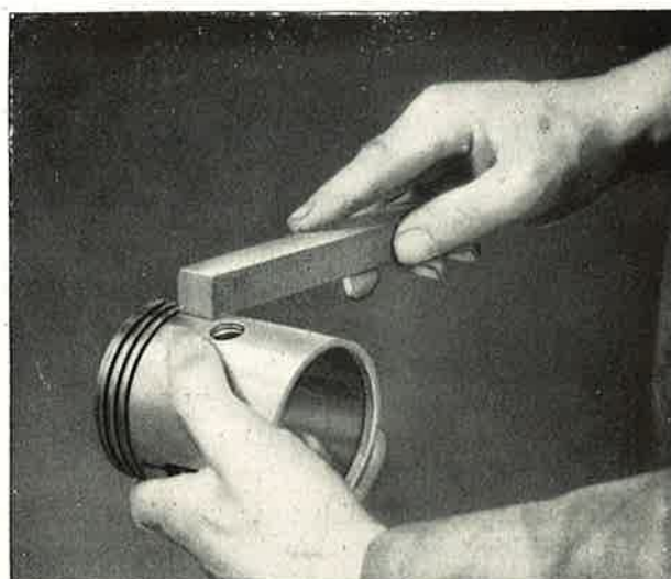
Kuva M 33. Männän pinnassa olevien vähäisten leikkautumien tasoittaminen bensiini-öljyseoksessa kostutetulla korundikivellä
