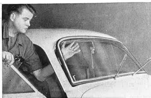
Kuva K 16. Tuulilasi painetaan irti korista
