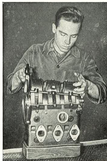
Kuva M 26. Kampikammion alaosan irrottaminen tai kiinnittäminen
