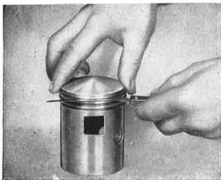
Kuva M 36. Männän renkaiden sivuttaisvälyksen mittaaminen
