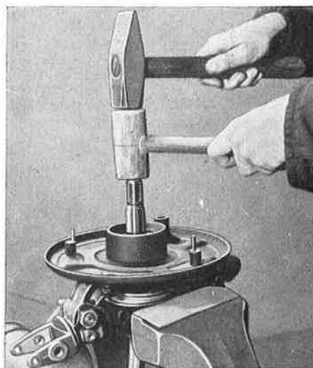
Kuva F 47. Ulompi vetoakseli isketään irti pyörän navan laakerista
