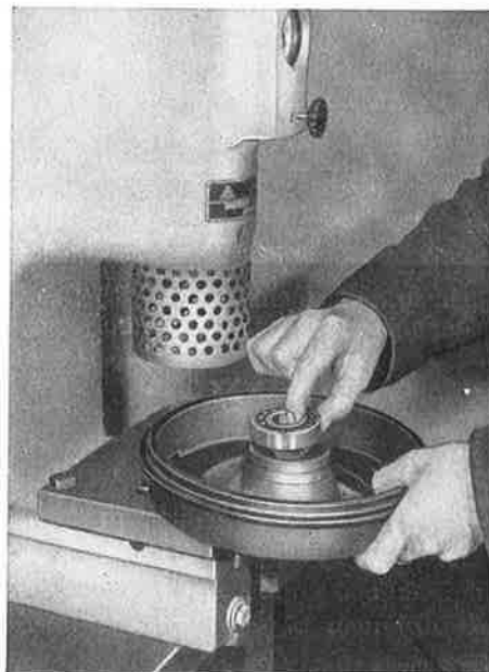
Kuva F 86. Sisempi kuulalaakeri painetaan jarrurummun napaan käsipuristimessa
