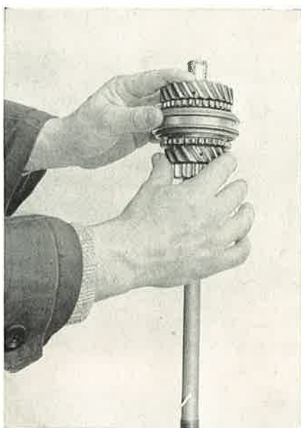
Kuva G 114. Pyörien tarkastaminen ennen asentamista
