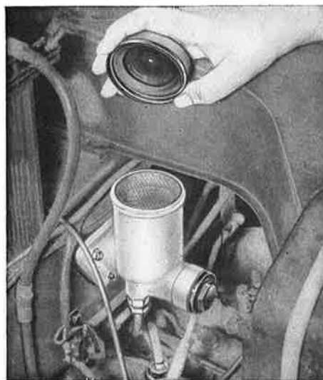
Kuva F 111. Keskusvoitelupumppu moottoritilassa
