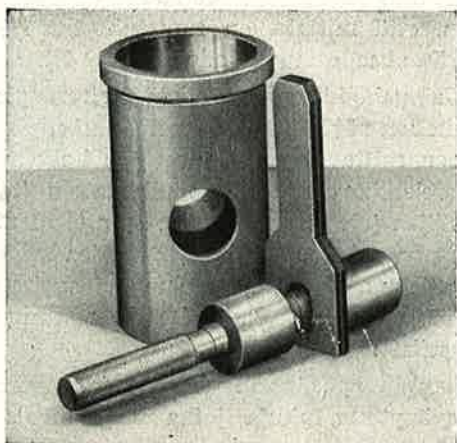
Kuva G 48. Säätötulkki W-86 915 ja käsipultti W-86 916 lautas- ja kartiopyörän toleranssin tasoittamista varten
