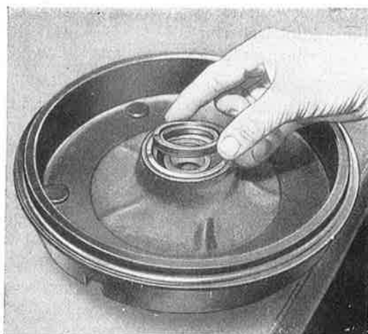
Kuva F 90. Öljytiivisterengas sijoitetaan takapyörän napaan
