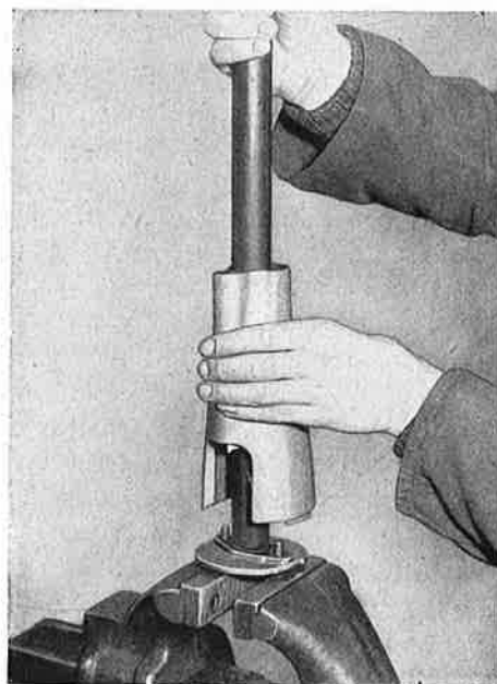
Kuva F 14. Ohjausputken vaipan kiinnittäminen
