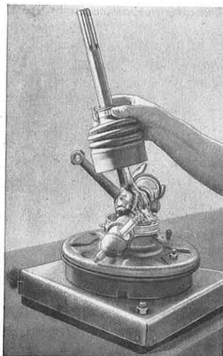
Kuva F 65. Olka-akselin koppa täytetään erikoisvaihteistorasvalla
