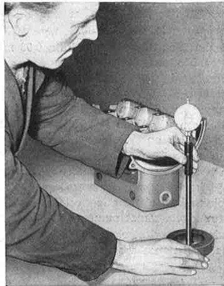
Kuva M 27. Sylinterien mittakellon säätäminen asetusrenkaan avulla (70 mm \phi )
