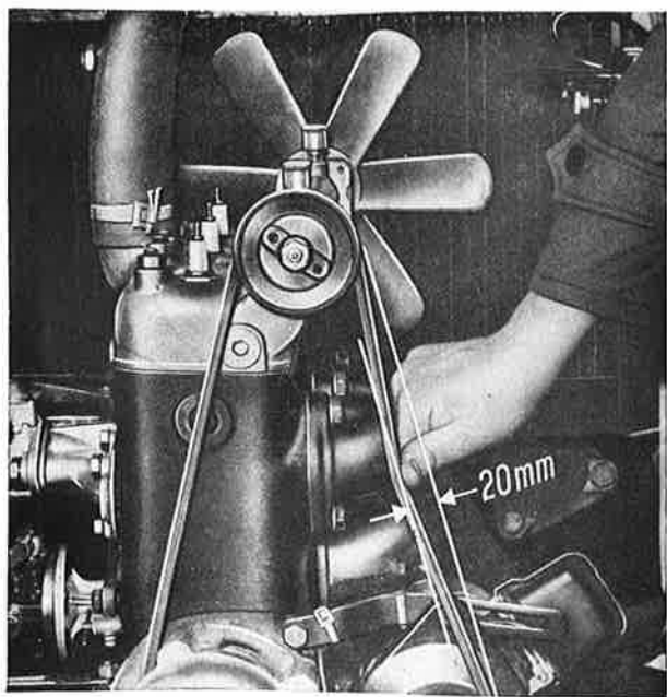
Kuva M 57. Kiilahihnan tiukkuuden tarkistaminen
