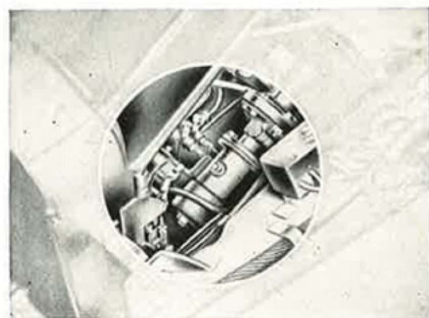
11 Ohjausnivel voidellaan joka 5 500—6 000 km:n jälkeen
