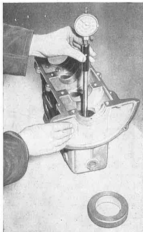
Kuva M 28. Sylinteriporausten mittaaminen säädetyllä mittakellolla
