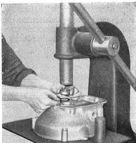
Kuva G 35. Kuulalaakeri ja välirengas painetaan käsipuristimessa kytkinkoteloon
