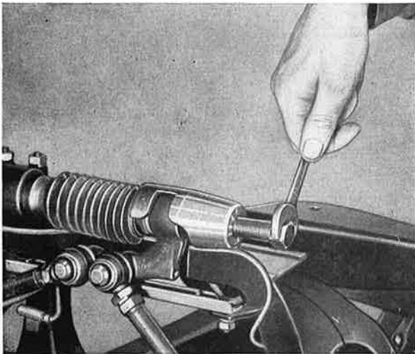
Kuva F 30. Ohjausvarsi irroitetaan ulosvetäjällä W-83 587
