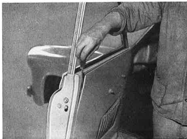
Kuva K 2. Oven sisäpäälysteen pehmustehakasten irroittaminen
