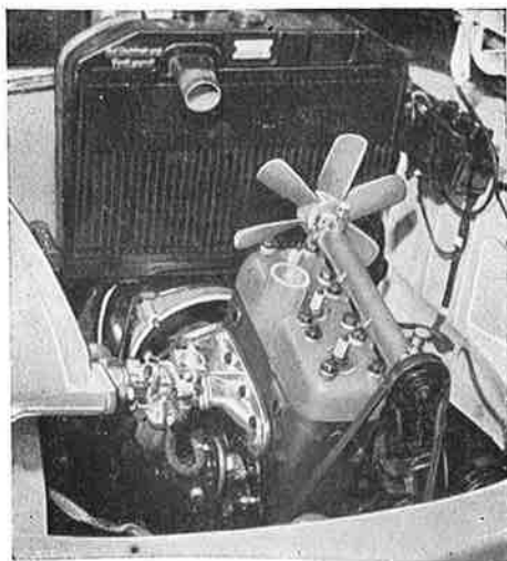
Kuva M 11. Moottorin liittimet ja kiinnitysruuvit on avattu ja moottori voidaan nostaa pois
