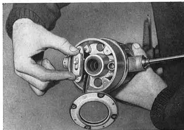
Kuva F 10. Suuntavilkkujen luistikatkaisimen irroittaminen
