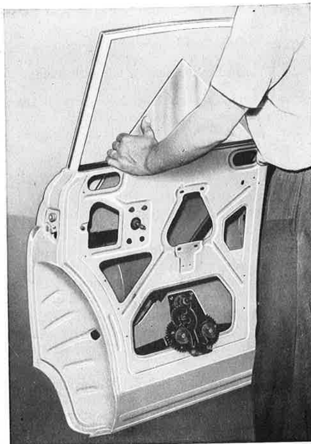
Kuva K 5. Takaoven ikkunalasin ja kampikoneiston poistaminen
