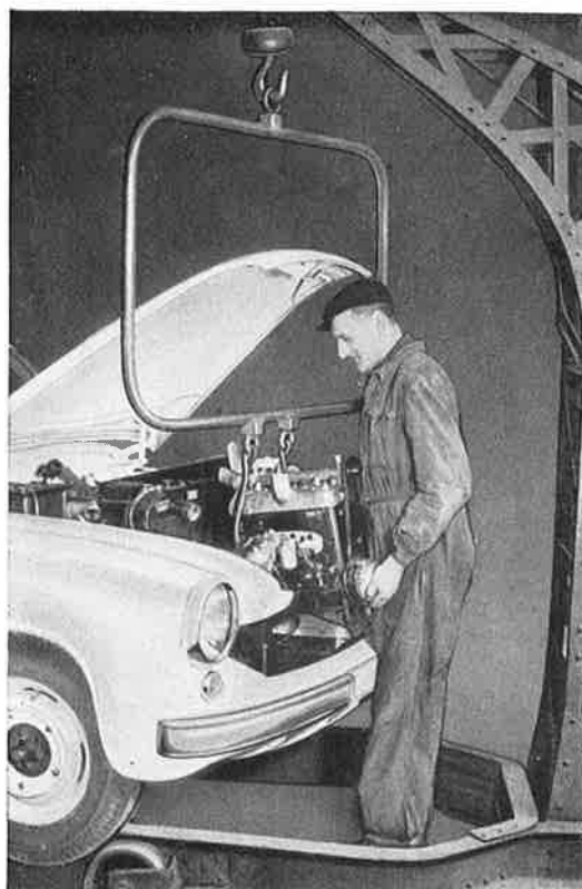
Kuva M 16. Moottorin nostaminen taljalla
