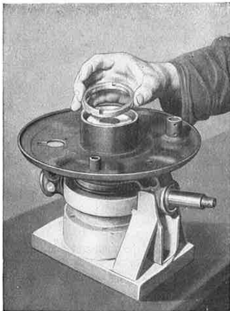
Kuva F 52. Rengasmutteri kiinnitetään olka-akseliin
