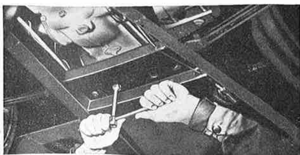
Kuva G 2. Vaihdelaatikko irroitetaan rengasavaimella
