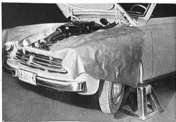
Kuva M 1. Auto nostettuna pukille ja etulokasuojat peitetty
