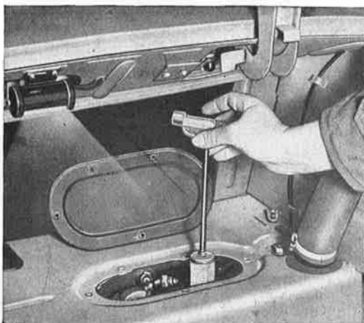
Kuva M 62. Polttoainesäiliön nousuputken irroittaminen
