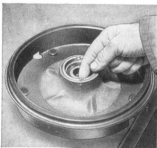
Kuva F 89. Rengasmutteri varmistetaan sokalla
