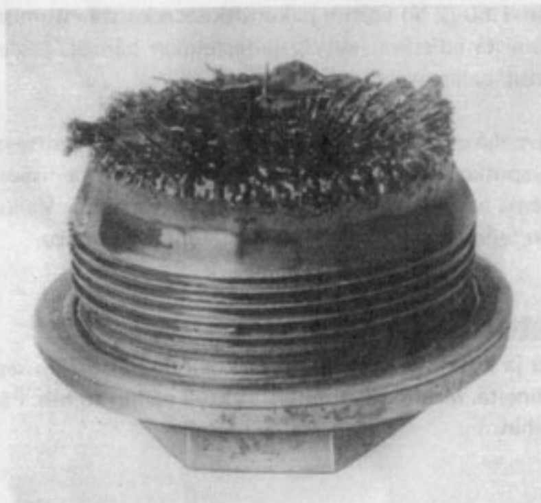
Kuva 28 Vaihteiston tyhjennysruuvi. Magneettiin kerääntyneet suurehkot metallihiukkaset ovat merkinä vaihteiston mahdollisesta vaurioitumisesta
