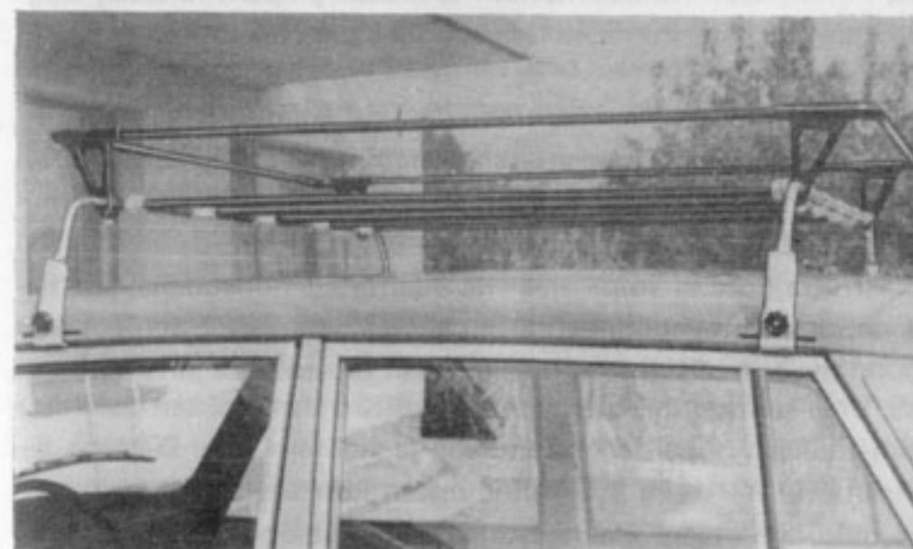
Kuva 7. Kattotelineen tulee nojata reunakouruun neljässä kohdassa ja kiinnittyä neljällä kiristimellä
