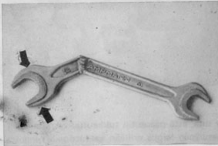
Kuva 15. Kaasuttimen purkamisessa käytettävä kiintoavain, joka on taitettu ja leuoista hiomalla ohennettu
