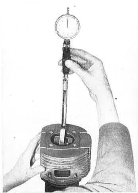
Kuva M 32. Sylinterin halkaisijan mittaaminen
