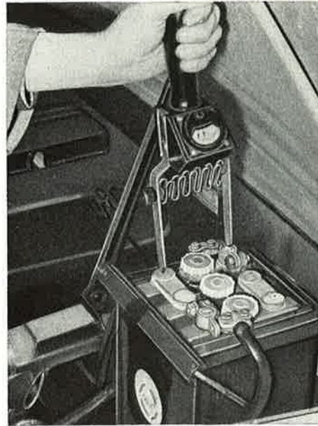
Kuva E 18. Akun jännitteen mittaaminen
