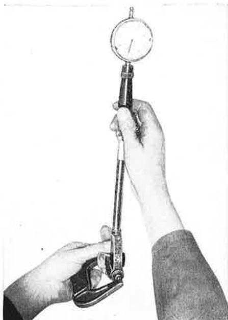
Kuva M 31. Mittakellon säätäminen
